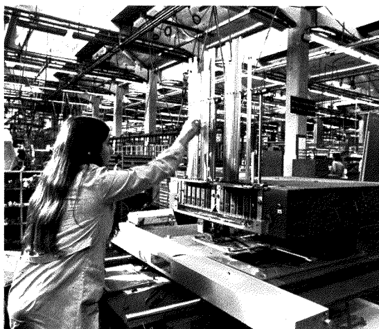
Fase di collaudo dei circuiti integrati del livello 62.
