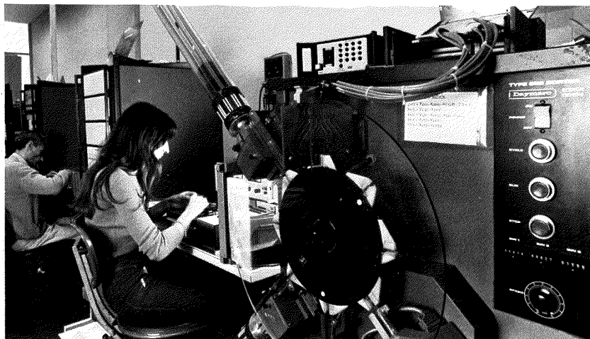
Fase di collaudo dei circuiti integrati del livello 62.
